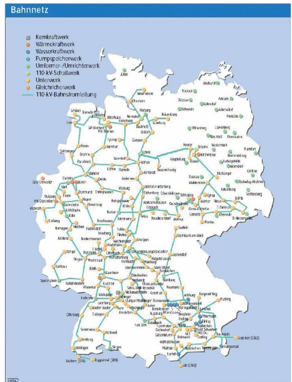
Bild 15: 110-kV-Bahnnetz, 16 2/3 Hz, Stand 01.09.1996 [5]
