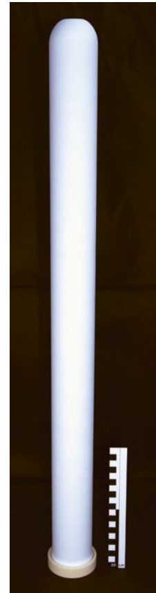
Bild 5 Isostatisch gefertigtes Beta-Alumina-Rohr des Unternehmens Haldenwanger (© Rozumek/ Morgan Advanced Materials Haldenwanger)
