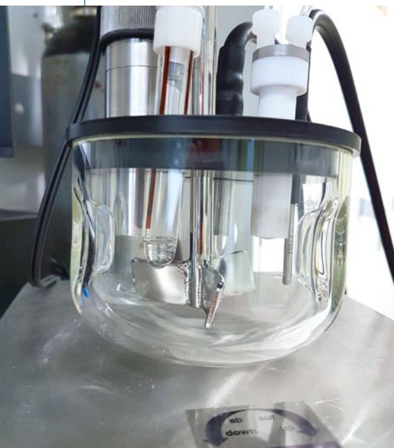
Bild 1 Gerät zur Bestimmung elektrischer Ladungen auf Partikeloberflächen in Feuerbetonen (© Forschungsgemeinschaft Feuerfest)
